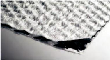
Geodren DC (Geonet) es un geocompuesto que consiste en una geomalla y un material no tejido de filtro en uno o en ambos lados. El Geonet está hecha de polietileno de alta densidad (HDPE), el material no tejido de filtro consiste en polipropileno (PP). Se caracteriza por una baja capacidad de compresión, por lo que se utiliza en situaciones donde se requiere drenaje efectivo bajo altas presiones.
