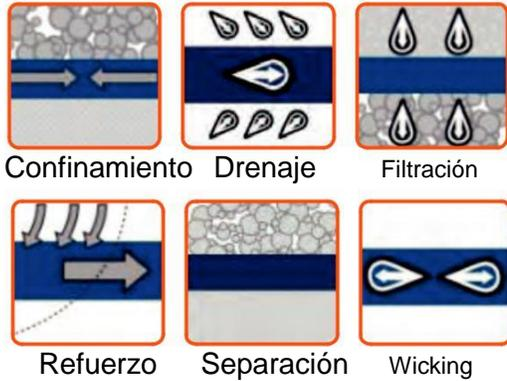
H2Ri es un geotextil revolucionario creado a partir de filamentos de polipropileno de alta tenacidad súper formados en un tejido innovador para proporcionar fuerza en el refuerzo superior y la interacción del suelo, integrado con alto flujo de agua y la capacidad de retención del suelo.
