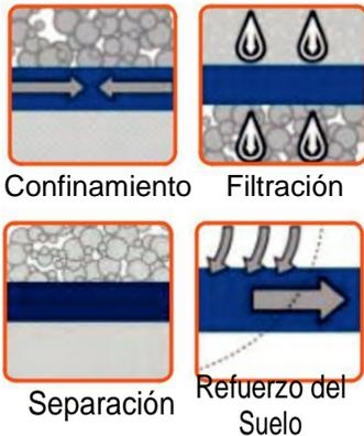
Rs280i es un geotextil revolucionario creado a partir de filamentos de polipropileno de alta tenacidad súper formados en un tejido innovador para proporcionar fuerza en el refuerzo superior y la interacción del suelo, integrado con alto flujo de agua y la capacidad de retención del suelo.
