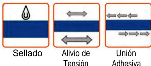
La tela no tejida para revestimiento asfáltico Mirafi® MPV500, forma una membrana que minimiza la penetración de agua superficial en los sistemas de pavimentación y provee una capa intercalada de alivio de esfuerzos que inhibe el crecimiento de grietas reflexivas.
