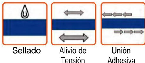
La tela no tejida para revestimiento asfáltico Mirafi® MPV600, forma una membrana que minimiza la penetración de agua superficial en los sistemas de pavimentación y provee una capa intercalada de alivio de esfuerzos que inhibe el crecimiento de grietas reflexivas.
