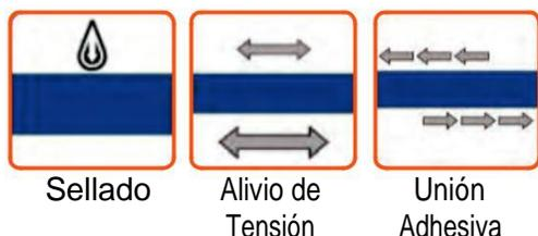
La membrana autoadhesiva impermeabilizante Mirafi® MTK, se fabrica a base de caucho, asfalto y telas no tejidas de polipropileno reforzado. Esta membrana actúa como una barrera de humedad que resiste la penetración o infiltración de agua y se usa principalmente para aplicaciones de revestimiento asfáltico. La membrana impermeabilizante Mirafi® MTK proporciona un refuerzo a largo plazo que prolonga la vida del pavimento.
